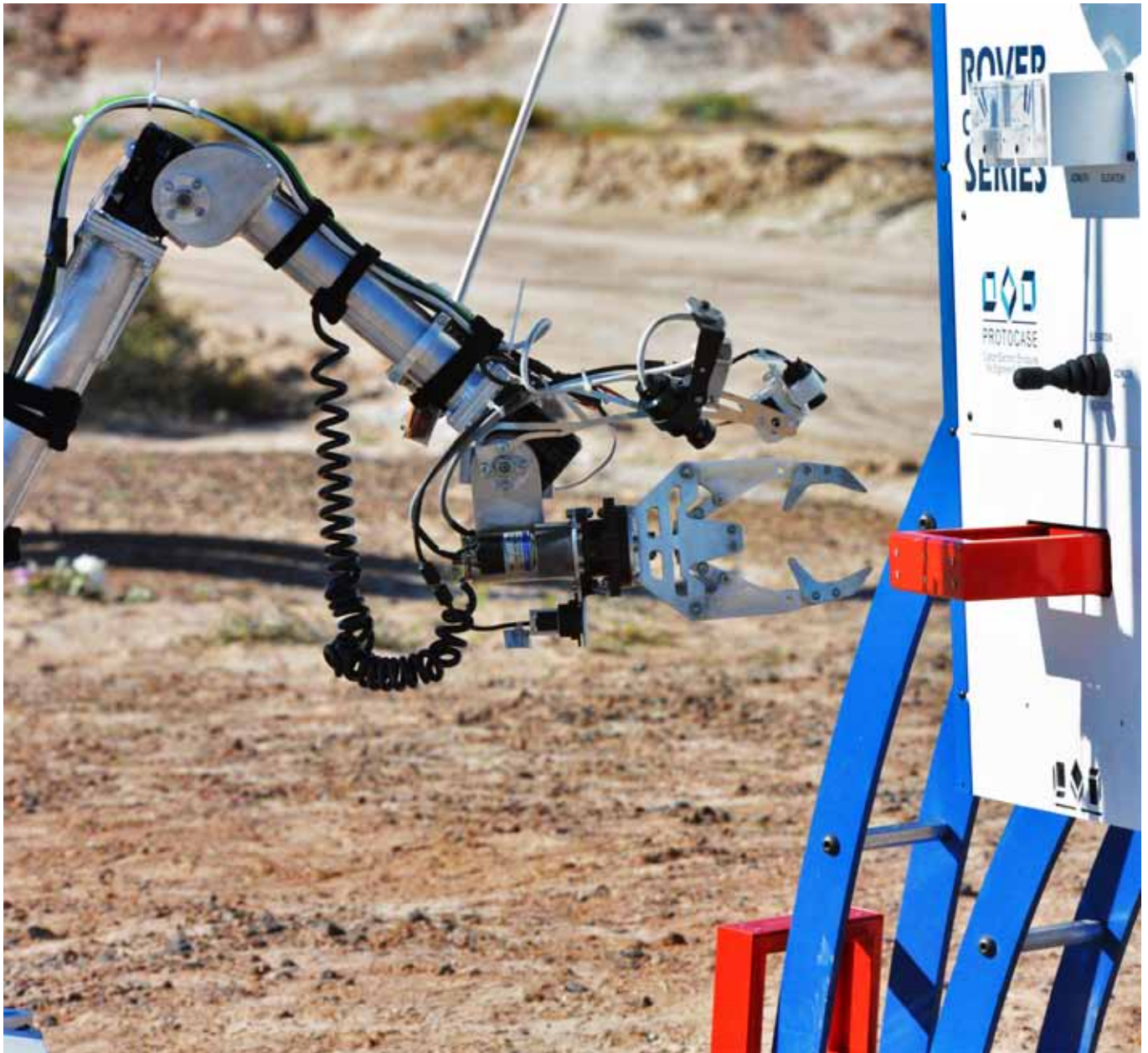
Zadanie serwisowe polegało na zdalnej obsłudze elementów szafy sterowniczej
