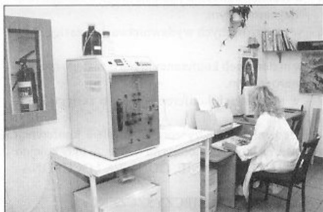
Laboratorium metod instrumentalnych – analizator ogólnego węgla organicznego.
