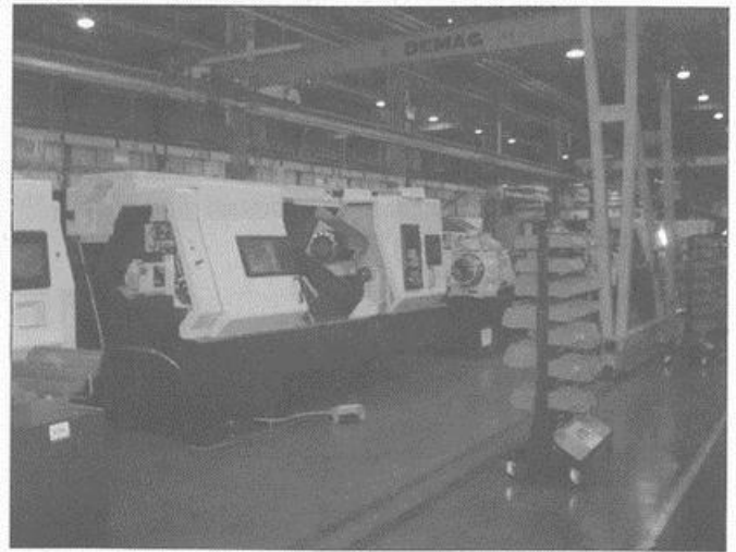
Obrabiarka na końcowym etapie montażu
