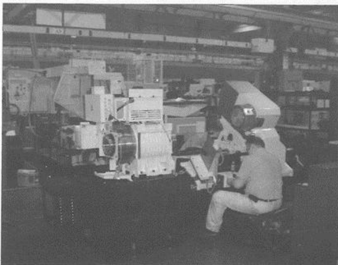
Tokarka z zamontowanymi wrzecionami roboczymi i głowicą narzędziową
