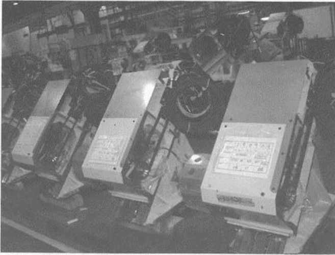
Główce narzędziowe obrabiarek przygotowane do montażu
