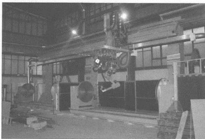
Zrobotyzowane stanowisko do spawania zespołów maszyn górniczych metodą tandem dla firmy Patentus (Pszczyna)
