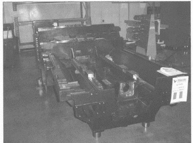
Łoże tokarki z prowadnicami wzdłużnymi i poprzecznymi
