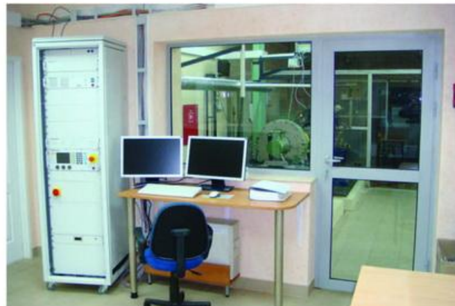
Pomieszczenie sterowni Laboratorium badania silników spalinowych Instytutu Maszyn Tłokowych i Techniki Sterowania Politechniki Częstochowskiej - widoczna szafa sterownicza z modułami systemu sterowania programowalnego hamulca wiroprądowego SCHENCK W230 oraz modulem systemu automatyzacji badań silnika spalinowego STARS LITE
