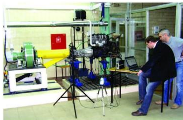
Dr inż. Michał Gruca i dr inż. Arkadiusz Jamrozik z IMTiTS PCz podczas badań drgań i hałasu silnika spalinowego z wykorzystaniem systemu PULSE w Laboratorium badania silników spalinowych
