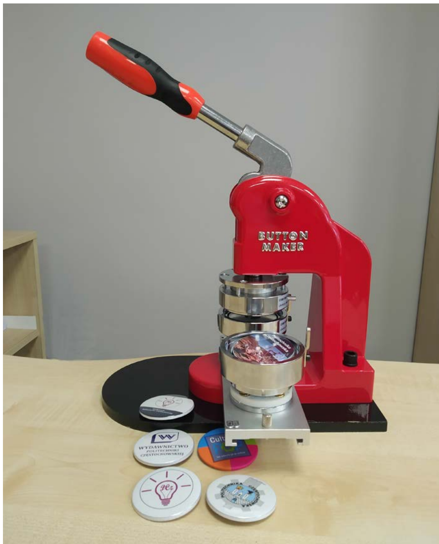
Urządzenie poligraficzne do produkcji znaczków reklamowych
