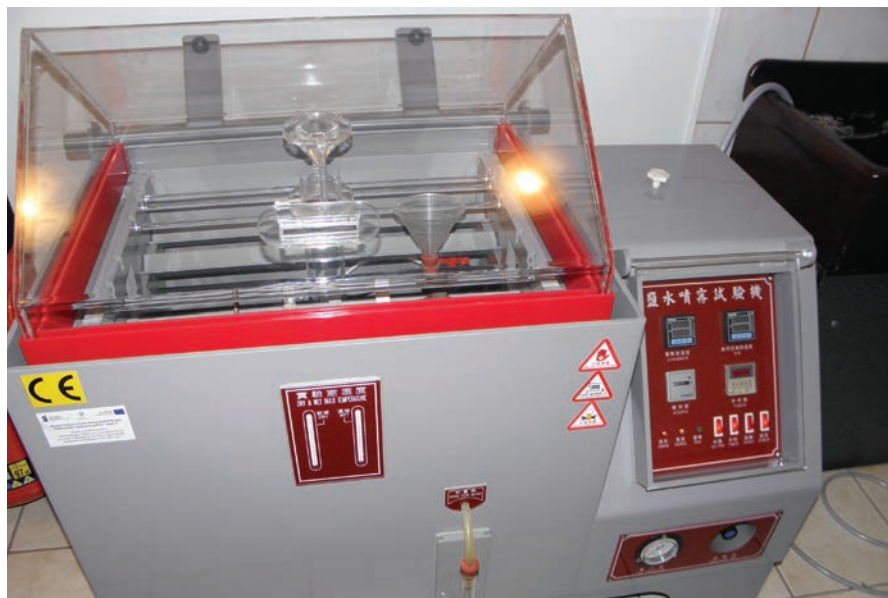
Komora solna do badań korozyjnych metali QC-711M/L
