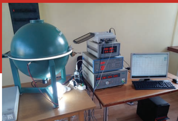
Badanie źródeł i opraw oświetleniowych
