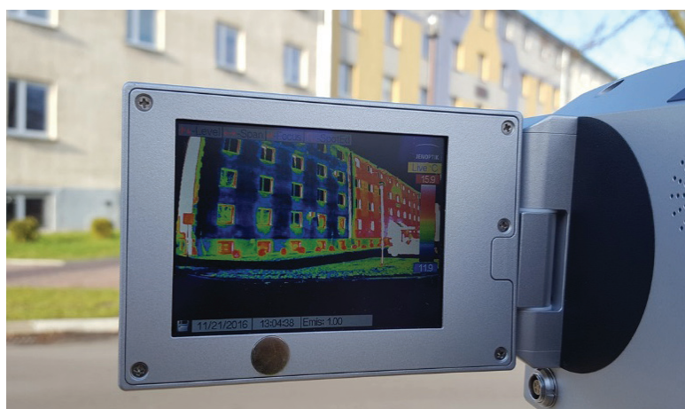
Kamera termowizyjna do lokalizacji defektów na konstrukcjach i instalacjach budowlanych
