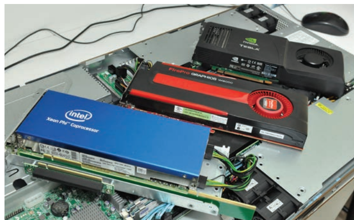
Systemy HPC z akceleratorami obliczeniowymi Xeon Phi 7120P, AMD FirePro W8000, NVIDIA Tesla C1060 i NVIDIA GeForce GTX Titan
