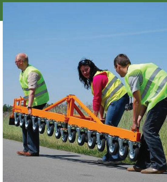
Planograf - urządzenie do badania równości podłużnej nawierzchni drogowych
