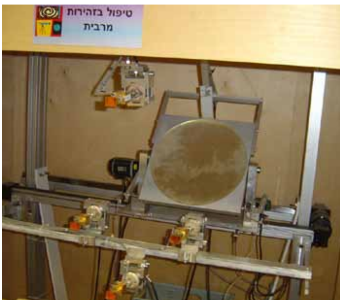
Laboratorium obrazowania terahercowego (THz) - stanowisko badawcze z nadajnikami i odbiornikami promieniowania THz
