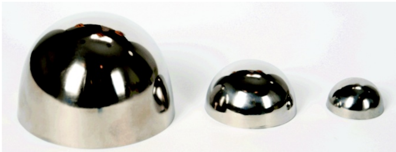
Realizacja projektu dąży do wypracowania rozwiązań innowacyjnych służących poprawie konkurencyjności sektora lotniczego oraz ich wdrożeniu do przemysłu – technologia kształtowania blach tytanowych na zimno opracowana w PCz
